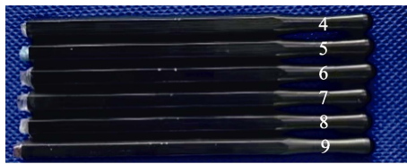
图 4 莫氏硬度笔 Fig.4 Mohs hardness pen
