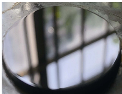
图9 钽晶圆抛光后图像
