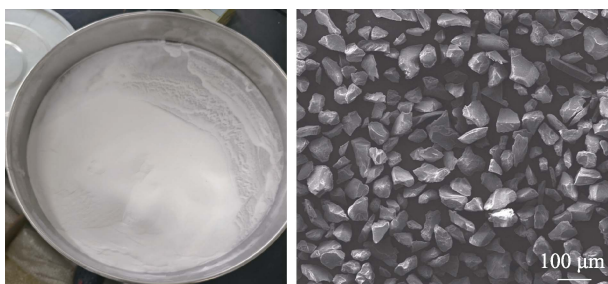
图 5 Al 2 O 3 颗粒和 SEM 形貌 Fig.5 Al 2 O 3 particles and SEM morphology
