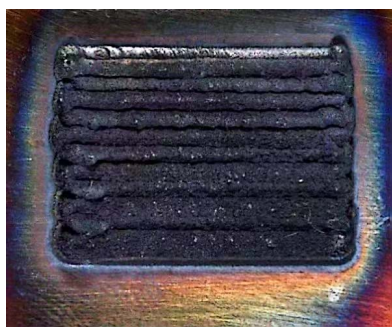
图 6 多道熔覆层 Fig.6 Multi-channel cladding layer
