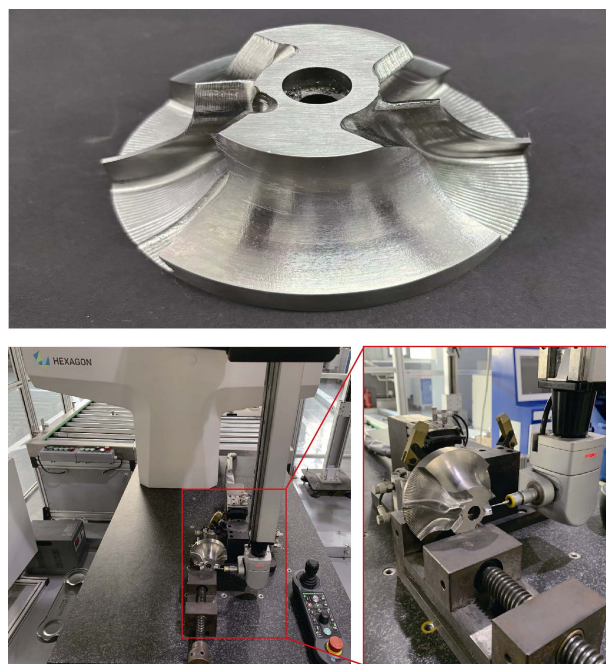
图 8 叶片型面及叶片型面尺寸测量试验现场 Fig.8 Blade profile and blade profile size measurement test site
