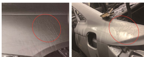
a 涂装线脱脂工艺处镀锌板脱脂不良照片 b 脱脂不良时镀锌板磷化膜外观照片
