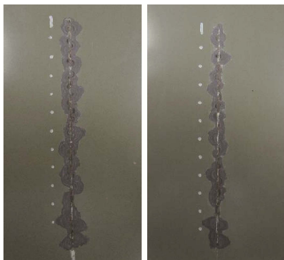
a 脱脂不良时电泳板耐蚀结果 b 脱脂正常时电泳板耐蚀结果
