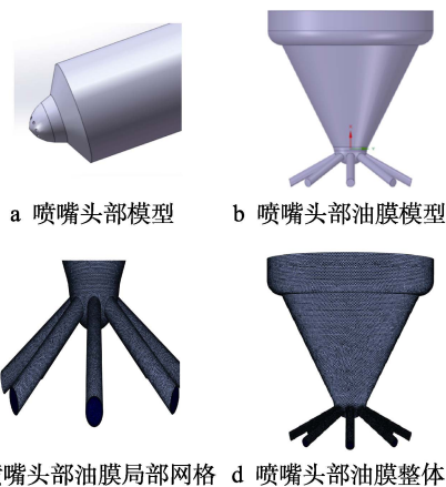
图 2 喷油器喷嘴头部模型、油膜模型及网格
