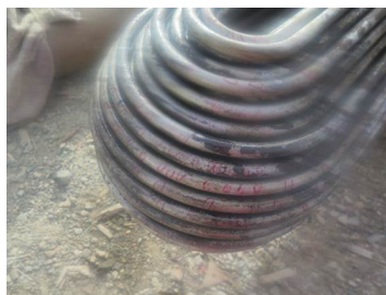
图 1 某油田重沸器换热管束宏观分析照片(标红处为裂纹)
