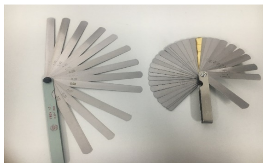
图 6 塞尺 Fig.6 Feeler gauge
