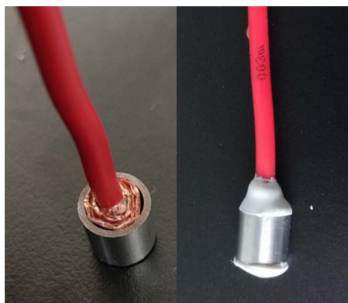
图 1 点蚀电位测试样品的制样方法
