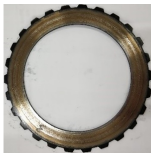
图 3 对偶钢片 #3 滑摩表面 Fig.3 Sliding friction surface of steel disc #3
