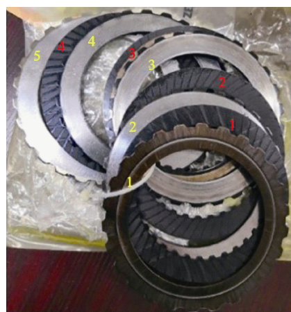
图 1 某湿式 DCT 摩擦副实物
