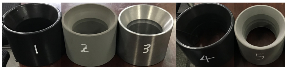
图6 各球座未冲蚀前宏观形貌
