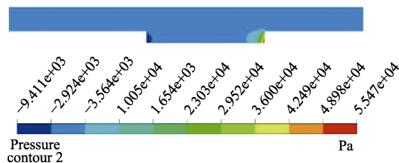
图8 对称面上油膜压力分布图
