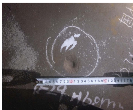
图 1 SRB 导致 Q235 罐板的局部腐蚀
