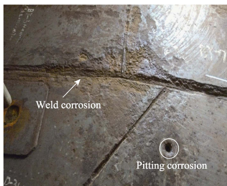
图 1 SRB 导致 Q235 罐板的局部腐蚀
