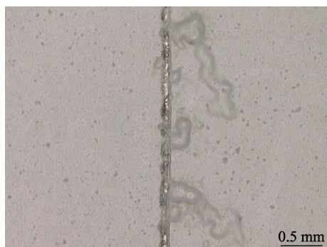
图 1 铝合金丝状腐蚀典型形貌
