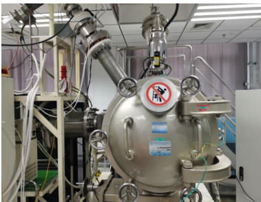
图 3 真空-质子电子辐照设备与试片摆放状态
