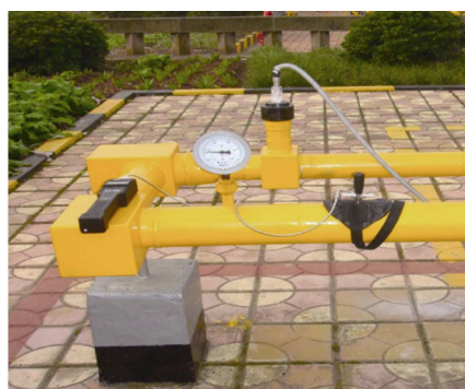
a 电化学氢通量探针在西南油气田腐蚀监测现场中的应用
