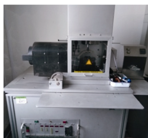
a SRV摩擦磨损试验机
