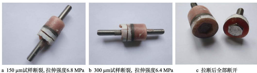
图 9 拉伸试样断裂后照片
