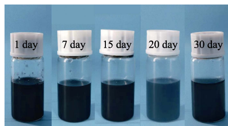
图 1 十八胺修饰 3DFCs 在 PAO-6 基础油中的分散情况 Fig.1 Dispersion of 3DFCs modified with octadecylamine in PAO-6 base oil
