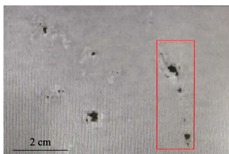
b 表面检查仪中漏镀缺陷形貌
