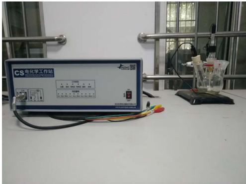
图 2 电化学耐腐蚀测试仪 Fig.2 Electrochemical corrosion tester
