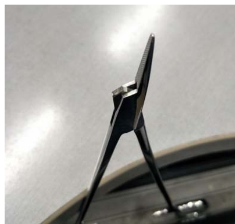
图 3 止血钳刃部断裂及宏观断口形貌
