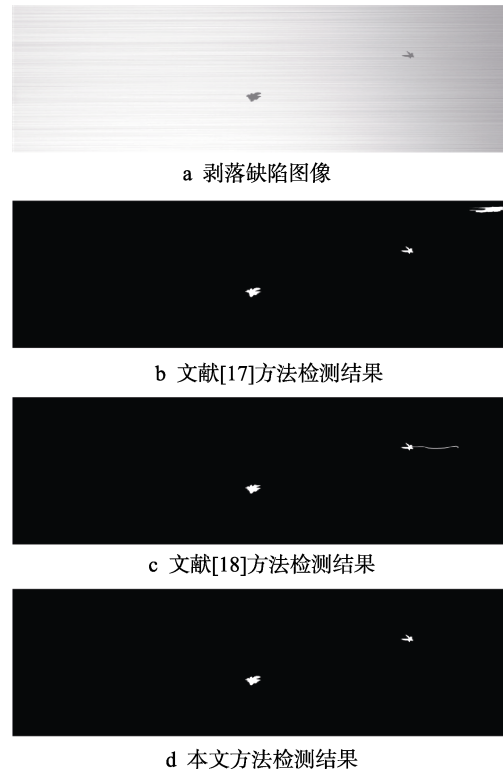
图 1 剥落缺陷检测结果
