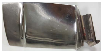
图13 试验用航空发动机叶片 Fig.13 The aero-engine blade used in test
