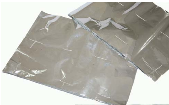
图 2 多层隔热材料照片 Fig.2 Photograph of multilayer insulation materials
