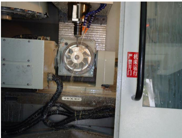
图 4 试件切削过程
