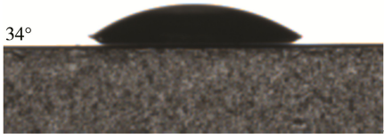
图 10 最佳水热条件处理后 Kapton 基材的水接触角 Fig.10 Water contact angle of Kapton substrate treated under optimal hydrothermal conditions
