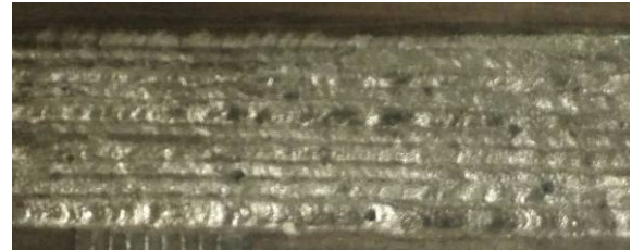
a 熔覆层整体形貌
