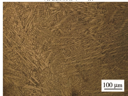
c 熔覆层搭接处放大200倍
