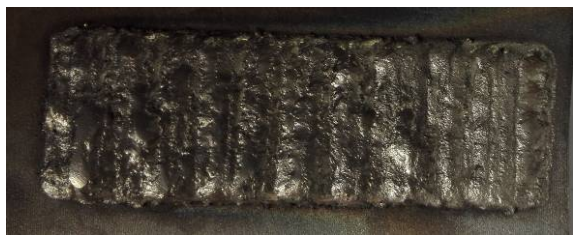
图 7 路径二熔覆形貌 Fig.7 Morphology of path II cladding
