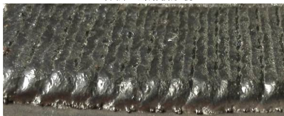
b 方法二的熔覆形貌
