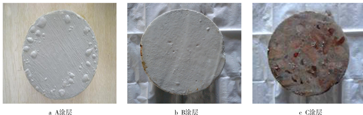
图2 RCM 试验后混凝土表面不同涂层体系宏观图
