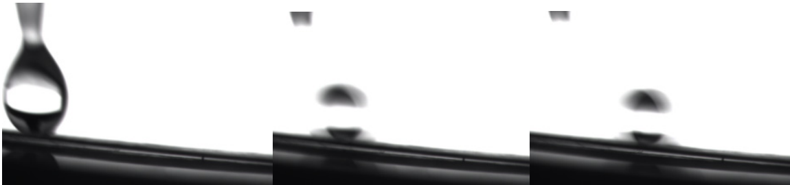
图 4 金属锌表面超疏水薄膜的动态接触角 Fig. 4 Dynamic contact angle images of superhydrophobic film on zinc
