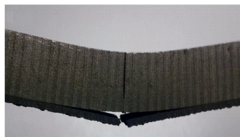
b 45°倾斜裂纹试样
