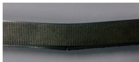
a 垂直裂纹试样
