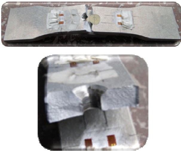
图 2 试验件典型破坏特征 Fig.2 Typical fracture picture
