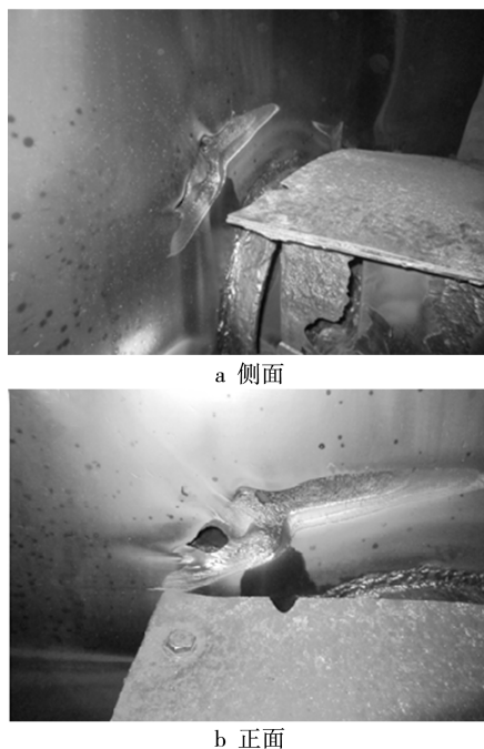
图 10 焦化分馏塔壁冲刷腐蚀形貌
