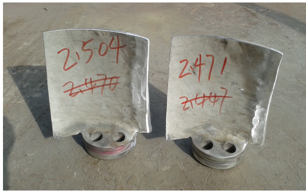
图 2 补焊后的一次风机叶片 Fig.2 Primary fan blades after repair welding
