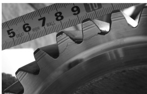
图 2 高速轴齿上的裂纹
