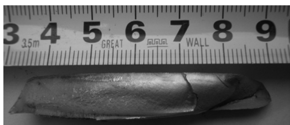
图 3 碎片断口形貌
