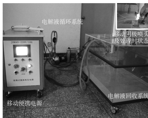
图1 喷射式微弧氧化装置现场图
