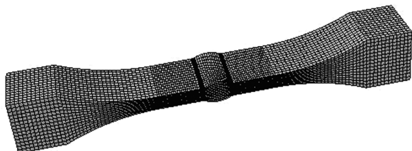
图2 对接接头模型的有限元网格
