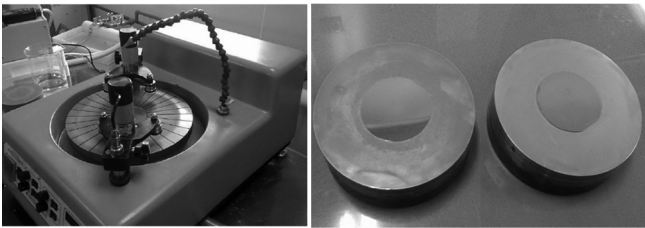
图 2 研磨抛光机和 SiC 单晶片
