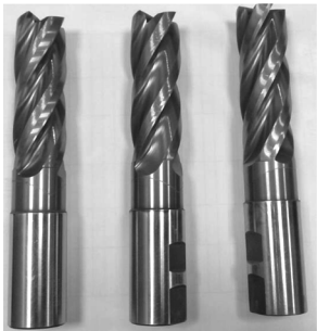
图 2 富含高 Si 的涂层铣刀 Fig. 2 Rich in high Si in TiAlN coated milling cutter
