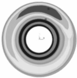
图 3 某时刻制动盘温度场分布 Fig. 3 Temperature distribution of disk at a specific time point
