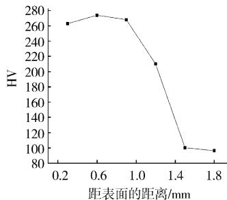
图3 熔覆层显微硬度分布曲线
