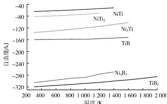
图1 涂层中可能反应的自由能随温度变化曲线
